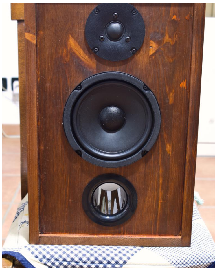
Casa completata, dall'alto: Tweeter, MidWoofer e Tubo di Accordo.
