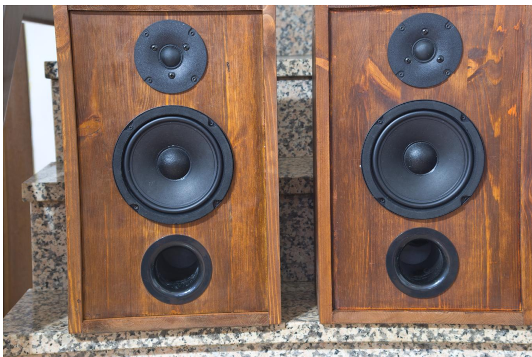
Casa completata, dall'alto: Tweeter, MidWoofer e Tubo di Accordo.
